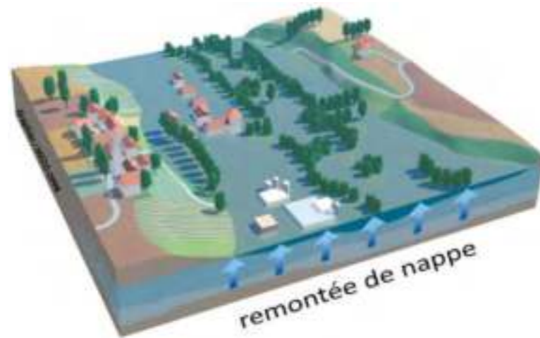
Figure 15 : Le phénomène d'inondation (Source : georisques.gouv.fr)
