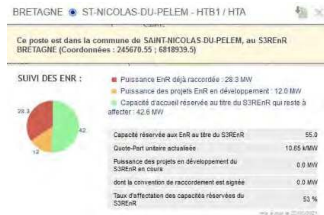
Figure 51 : Caractéristiques du poste de Saint-Nicolas du Pélem au 22/03/2021
